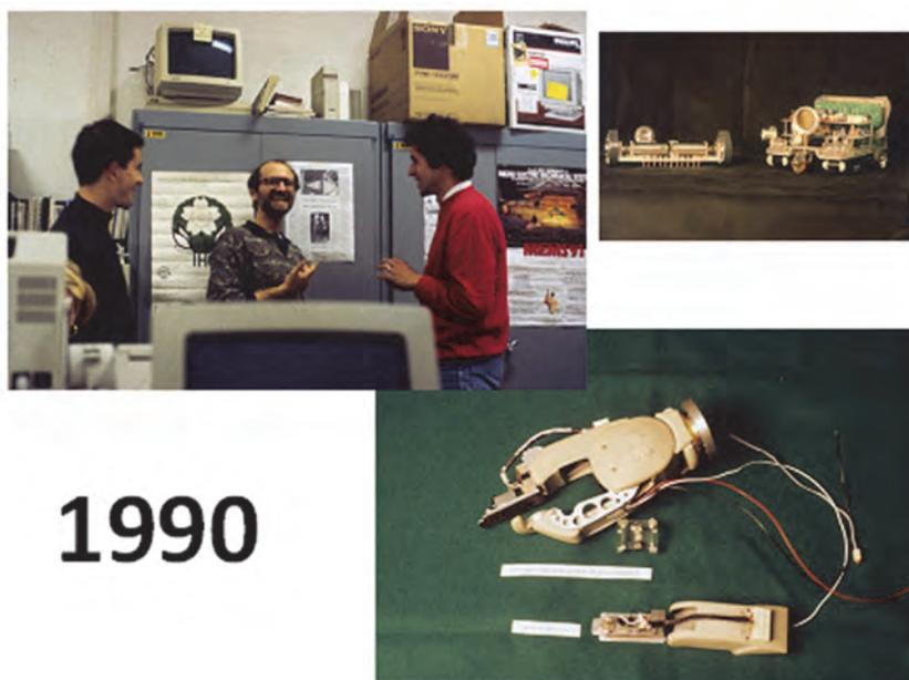
**Figura 3.** Uno dei primi prototipi di mano robotica realizzata presso il laboratorio ARTS della Scuola Superiore Sant’Anna di Pisa.
