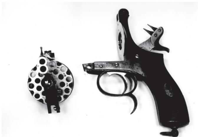
**Figura 48.** Il doppio percussore del revolver HDH.
