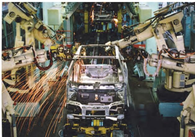
**Figura 10.** Stabilimento di Melfi, saldatura della Punto. Cortesia della Fiat Group Automobiles s.p.a.
