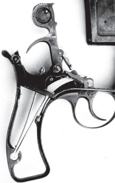
**Figura 12.** Il cane della Vitali con le due protruberanze.
