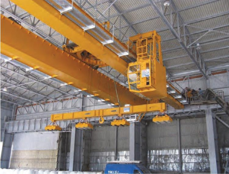
**Figura 4.** Ponte a cassone, luce 32 m, portata 20 t. Costruzione 2010. Per cortesia dell'ing. Riccardo Pollastri.
