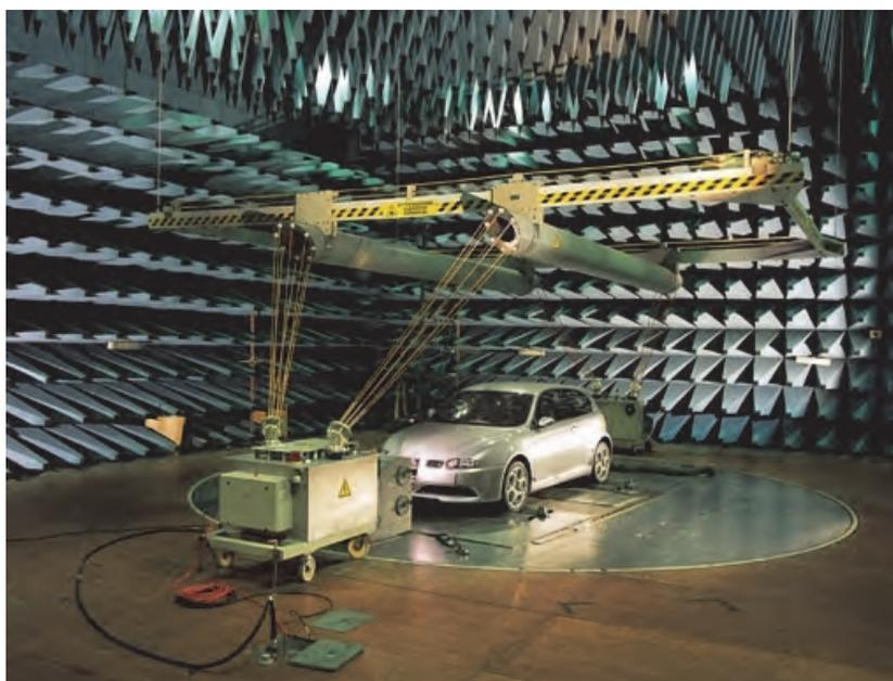
**Figura 12.** Elasis, camera anecoica per la compatibilità elettromagnetica. Cortesia di Elasis S.c.p.A.
