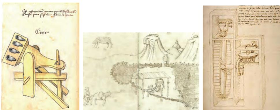
**Figura 14.** Alcuni disegni significativi dai manoscritti citati nel testo: a sinistra un cannone a più canne dal *Bellifortis*; al centro un progetto avveniristico del Taccola per l'uso del riflusso di marea come forza motrice per una ruota idraulica; a destra di Francesco di Giorgio la proposta di utilizzare un cavallo come motore per una ruota calcatoria.
