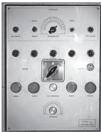
**Figura 9.** Pannello di controllo di una macchina per *packaging* degli anni Cinquanta del secolo scorso, in cui compare un primo esempio di utilizzo di sensore ottico (fotocellula). Archivio fotografico MPIB
