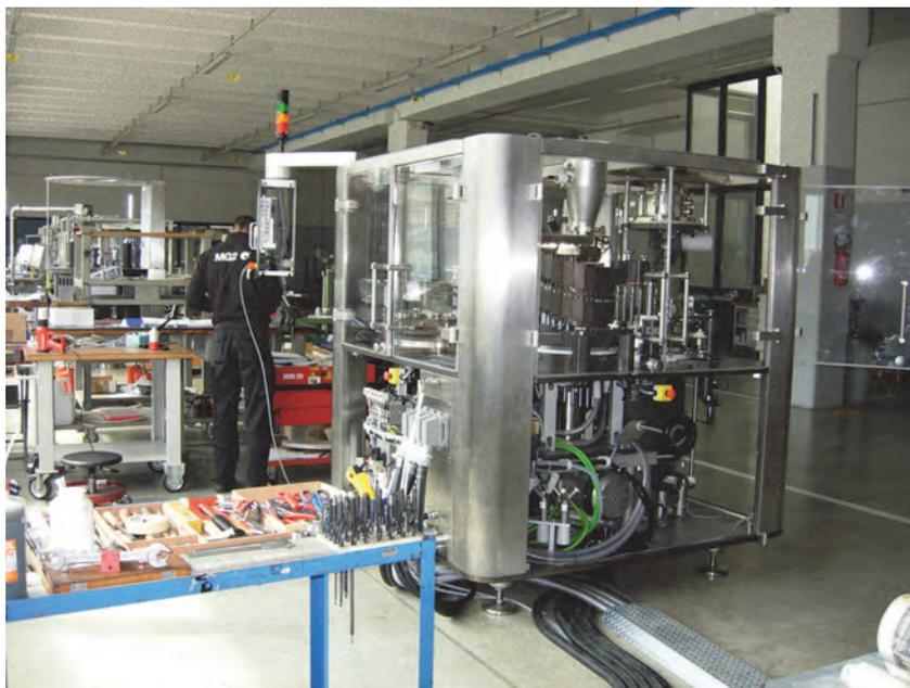
**Figura 29.** “MG2”, macchina MultiFLEXA 250 per riempire capsule con farmaci in polvere dotata di sistema MultiNETT per controllo peso netto al 100%. Archivio “MG2”
