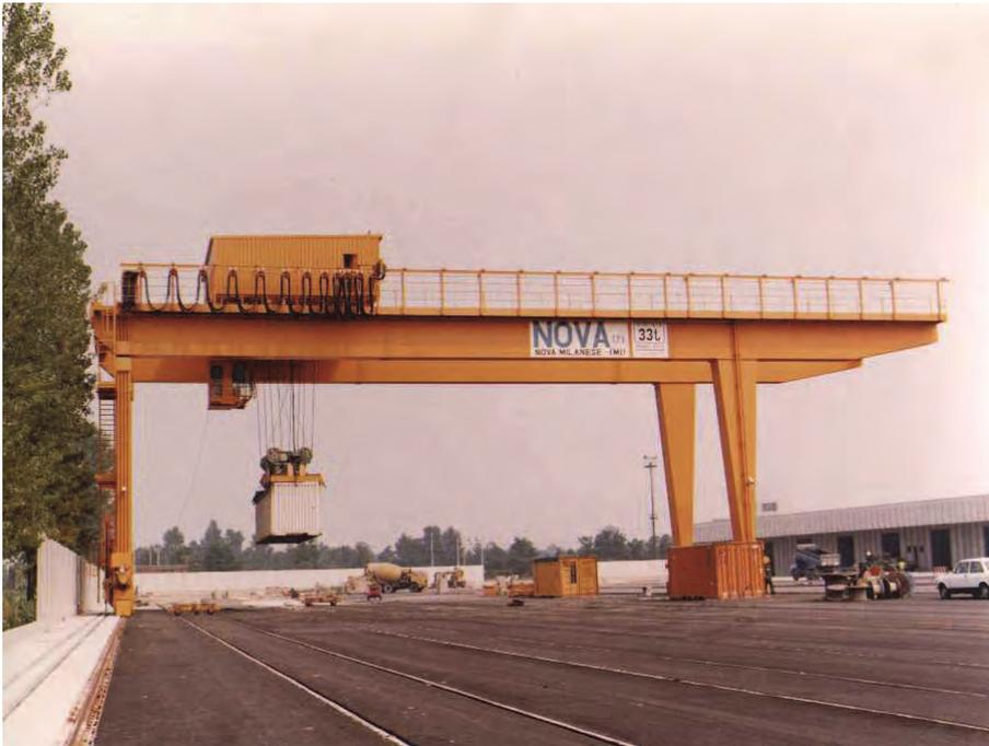
**Figura 7.** Gru a cavalletto per container. Per la cortesia della soc. BCV.
