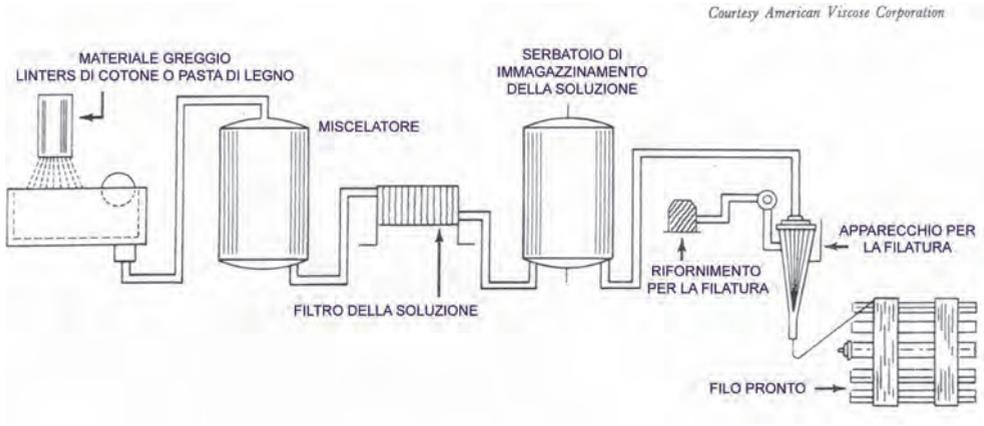
**Figura 2a.** Schema del processo industriale per il filato di rayon al cuprammonio.
