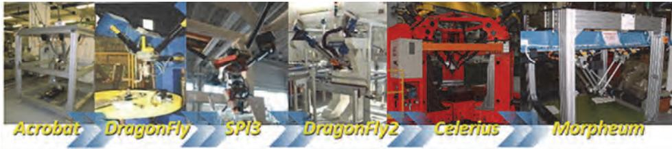
**Figura 3.** Famiglia di robot a cinematica parallela sviluppati da CNR-ITIA.
