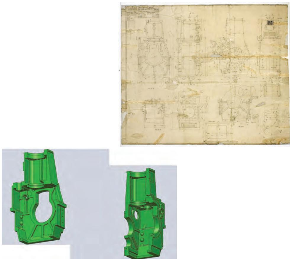
**Figura 58.** Il disegno di un particolare di motore Diesel, dall'archivio SAME di Treviso (in cui risulta evidente la necessità di un restauro conservativo) e la sua rielaborazione con un programma di modellazione tridimensionale.
