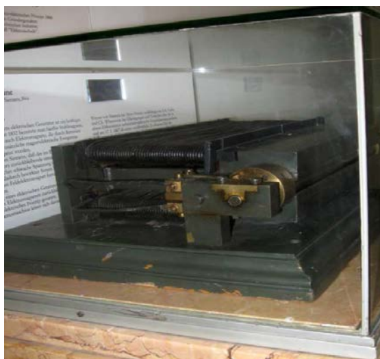
Fig. 19. Siemens' dynamo, 1866 (inv.-no. 59641)
