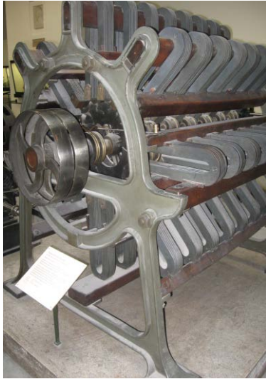
Fig. 4. At left: Alliance machine with disc armature, 1863 (inv.-no. 18043). At right: Sketch of an Alliance machine in service, from: LeRoux, F. P.: Les machines magnétoélectriques françaises et l'application de l'électricité à l'éclairage des phares . Gauthier-Villars Paris 1868, 95 pp.
